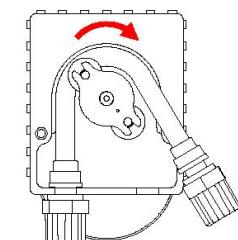
**I** Inserire il raccordo di destra nella propria sede e rimontare il coperchio avvitando le due viti del frontale
