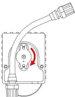
**I** Inserire il raccordo di sinistra del nuovo tubo, nella propria sede, facendo attenzione che la parte arrotondata si posizioni verso l'interno. Girare il portarullini in senso orario in modo che il tubo occupi la propria sede naturale
